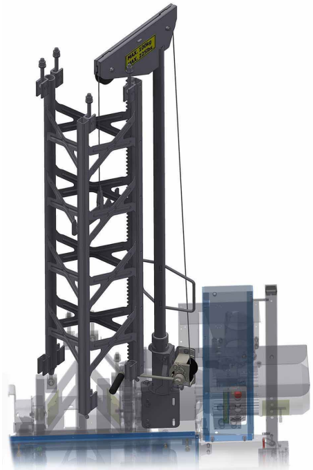
Afb. 96: Hijzen, positioneren van mastsegmenten
