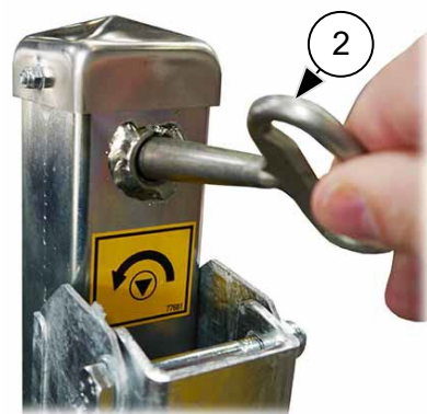
Afb. 56: Noodontgrendeling van de slagboom met elektromechanische vergrendeling
