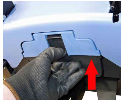
Afb. 55: Accu op basisapparaat inschuiven
