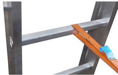
Afb. 33: Beveilig het kopstuk tegen wegglijden
