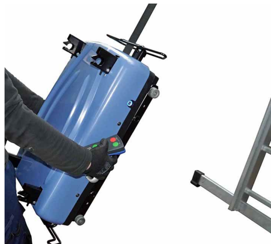
Afb. 37: Basisapparaat naar de ladderbaan tillen
