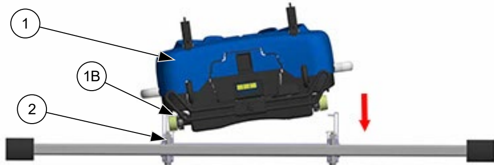
Afb. 42: Basisapparaat monteren op de ladder
